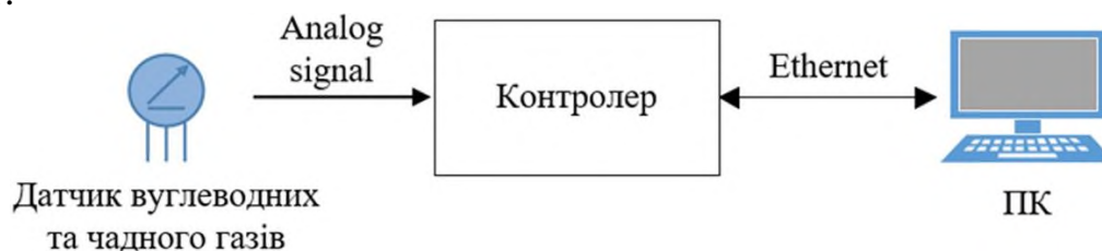
Рисунок 1 – Структурна схема системи моніторингу якості повітря
