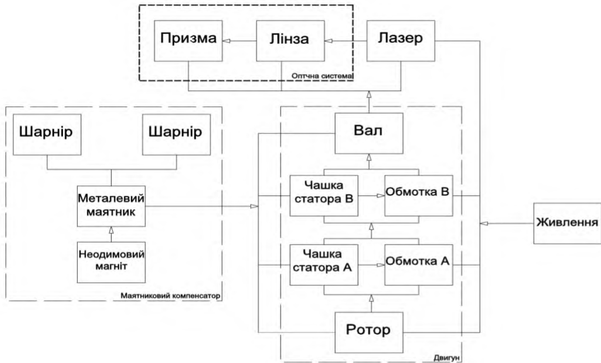
Рисунок 2 – Структурно-функціональна схема Bosch GRL 300 HVG Professional
